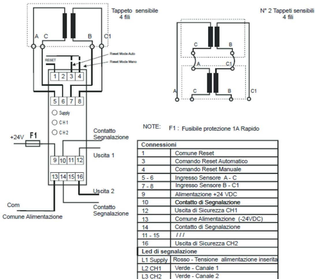
Modalità Reset Automatico: ponticellare e/o inserire contatti retroazione NC morsetti 1-3
