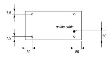
Tipo "C" Bastidor-placa enrasado con el parachoques y dotado de dominios prisioneros M6 con longitud 30 mm, para fijación con tuercas en el interior de la máquina.
