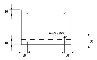
Tipo "B" Bastidor-placa enrasado con el parachoques y dotado de agujeros roscados (especificar la rosca al hacer el pedido) para fijación con tornillos en el interior de la máquina.
