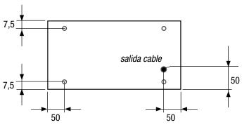
N.B. En los parachoques con longitudes superiores a 500 mm se realizarán ulteriores agujeros de fijación con un intereje de ≤500 mm entre un agujero y el otro.
